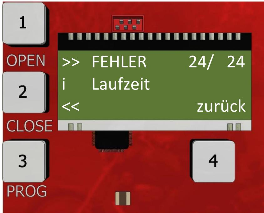
In diesem Menü finden Sie das Fehlerlogbuch. Sie können mit den Tasten 1 und 3 durch die Fehlerliste scrollen. Mit Taste 2 können Sie die Fehler auslesen. Mit Taste 4 gelangen Sie vom Fehler aus wieder zurück ins Logbuch. Für mögliche Fehlermeldungen siehe §13.
